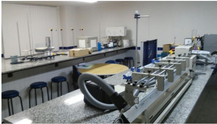
Figura 4: Trilho de ar utilizado no laboratório de Mecânica, Fluidos e Física Térmica
